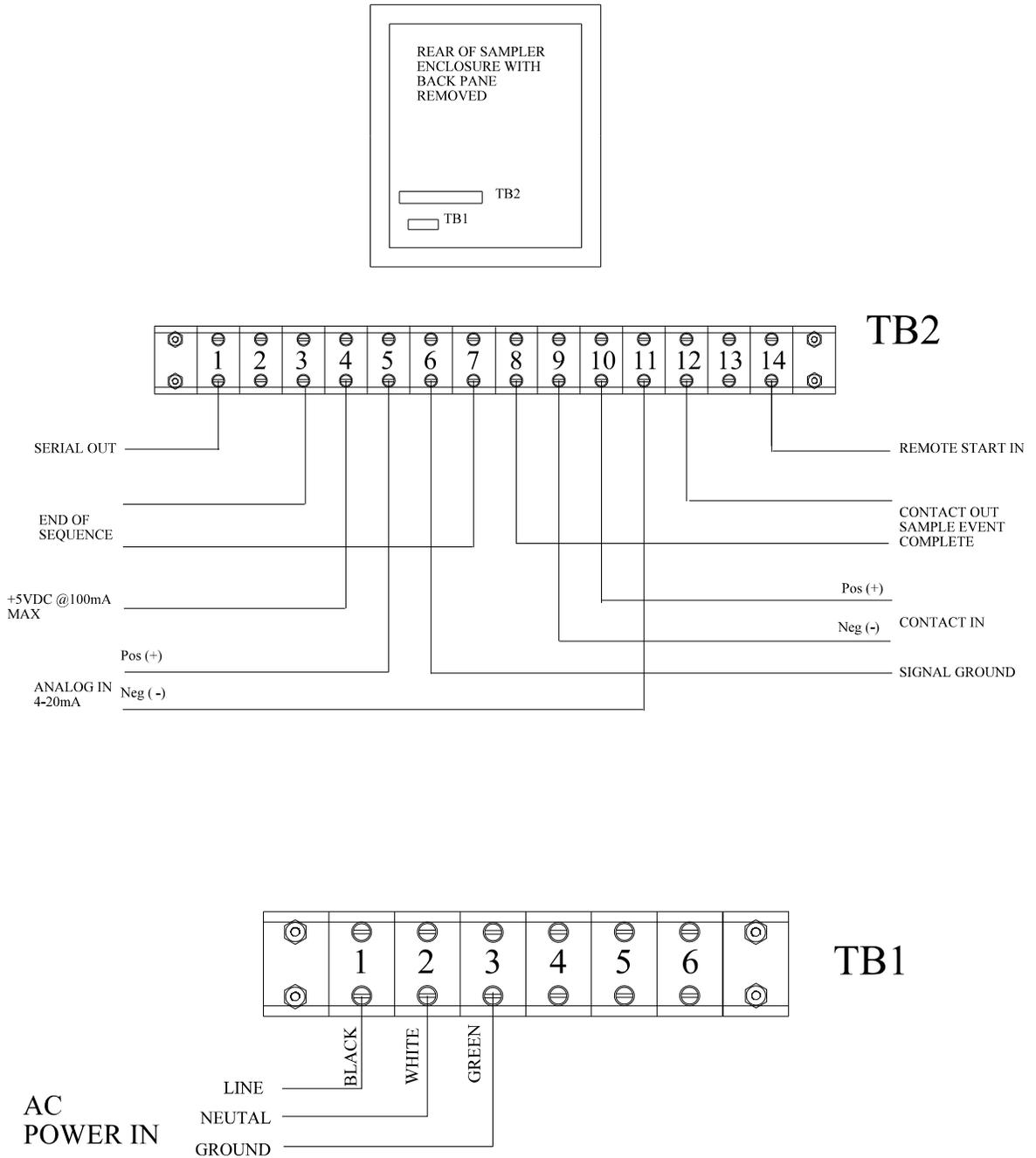
AC POWER CORD PROVIDED WITH SAMPLER IS ROUTED THROUGH LOWER WATER TIGHT FITTING ON RIGHT SIDE OF SAMPLER
